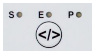
Abb. 6 Folientastatur Ausschnitt: Wahltaste und LED Anzeigen
