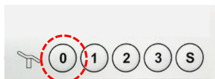
Abb. 16 Folientastatur Ausschnitt, Tasten für Stuhl Programmierung
